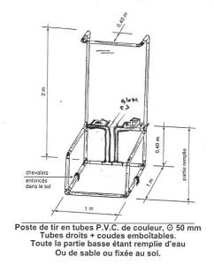
Firing Angle Limiter (Recommended model on new installations) Limiteur d'Angles de Tir (Modèle conseillé)
